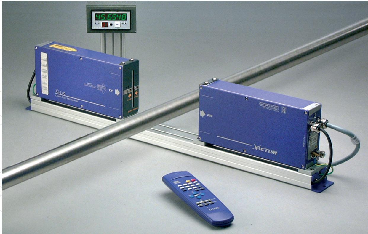
**Utilizzate i calibri laser intelligenti Xactum come strumenti per il controllo di diametro in linea, in versione Xporeline:**
