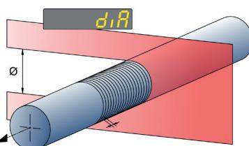
N è programmabile dall'utente ed al limite, per  $N=1$ , i Valori Instantanei coincidono con i Valori Singoli. La ripetibilità di misura dei Valori Instantanei si ottiene dividendo la ripetibilità a colpo singolo per la radice quadrata di N.
