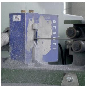
Tutti i valori di diametro misurati durante la produzione, oltre ad essere visualizzati sul display di un pannello CE-200, che funge anche da interfaccia operatore per la programmazione del sistema, possono anche essere memorizzati ed elaborati in modo da fornire un esauriente rapporto statistico per la certificazione di qualità.
