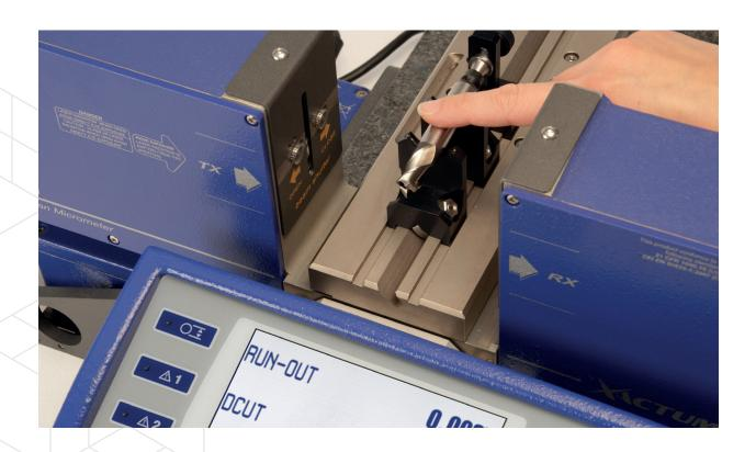
MECLAB.T40 est un instrument laser de haute précision pour le contrôle simple et précis du diamètre de barrettes et d'outils en métal dur, à tranchants pairs ou impairs. Idéal pour le contrôle de
