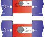
Meclab.T mesure simultanément le diamètre de la pièce D et la position du centre C ou bien les positions des bords de la pièce, Top (supérieur) et Bot (inférieur), toutes par rapport au centre du champ.
