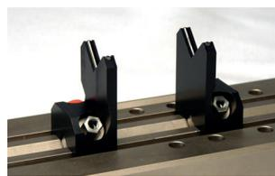
**Kapazität der Halterung:** Durchmesser des Einspannzapfens von 1 bis 20 mm, Länge des Einspannzapfens von 22 bis 100 mm, maximale Länge des Objektes 200 mm (für unterschiedliche Größen – kontaktieren Sie bitte Aeroel).
