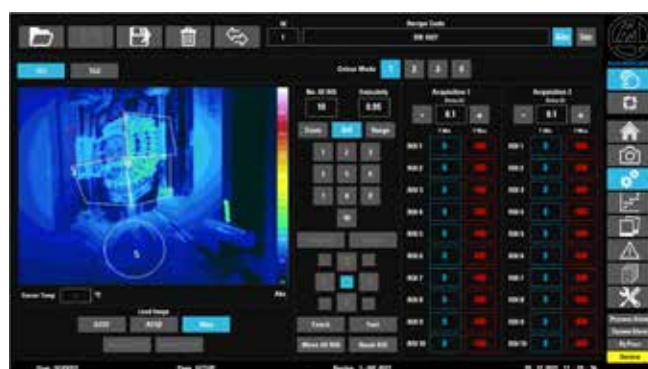
各ROIおよびレシピ設定パラメータの温度値を含むサーモグラフィ画像
