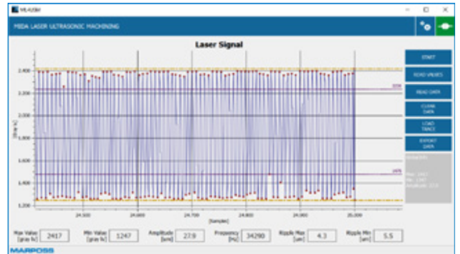
ML4USM ソフトウェア 工具振動計測のキャプチャ画面
