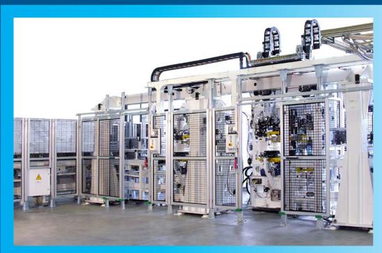
Marposs bietet maßgeschneiderte Lösungen für die Dichtheitsprüfung von Getriebegehäusen, die allen Anforderungen der Branche gerecht werden. Manuelle oder vollautomatische Maschinen mit einer breiten Palette an verfügbaren Optionen.
