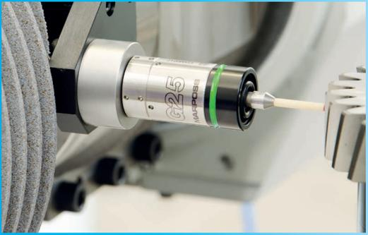
Die Überwachungssysteme sind so konzipiert, dass sie minimale Schwankungen der physikalischen Größen während der Schleifvorgänge erkennen und so eine äußerst präzise Steuerung der Vorschubgeschwindigkeit ermöglichen, wenn die Schleifscheibe das Teil oder den Abrichter berührt. Diese Systeme sind besonders nützlich, um Kollisionen zu vermeiden und eventuelle Maschinen- oder Werkzeugfehler, Absplitterungen an Schleifscheiben und Defekte des Abrichters zu erkennen.
