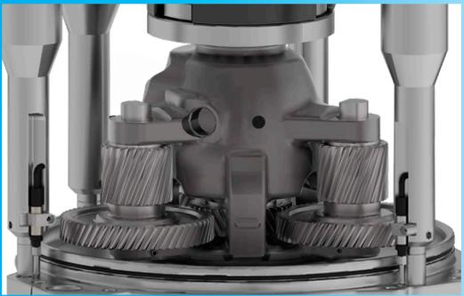
Der Prozess der Montage eines Hochgeschwindigkeitsgetriebes erfordert normalerweise die Bestimmung und Überprüfung der richtigen Passscheiben für die Montage, um Probleme zu vermeiden, die zu Geräuschen oder einer falschen Funktion des Getriebes führen können. Der Prozess der selektiven Montage von Passscheiben wird hauptsächlich zur Einstellung der Vorspannung eines Satzes von Kegellagern oder zur Einstellung des Spiels eines Paares von zusammenpassenden Zahnradern durchgeführt.
