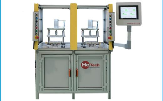
맞춤형 애플리케이션은 실제 작동 조건을 시뮬레이션하여 전기화학 반응되는 시스템 자체 또는 외부에 대한 기밀성을 검증합니다.
