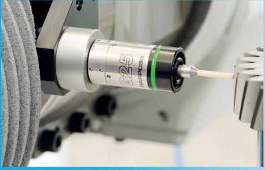
모니터링 시스템은 연삭 공정 중 물리적 크기의 미세 변화를 감지할 수 있도록 설계되어 연삭 휠이 가공 부품 또는 드레서에 닿을 때 이송 속도를 매우 정밀하게 제어할 수 있습니다. 이러한 시스템은 충돌을 방지하고 가공기 또는 공구 결함, 연삭 휠의 파편 및 드레서 결함을 방지하는 데 특히 유용합니다.
