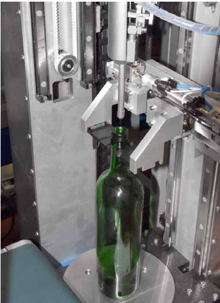
estación de medición de espesor de pared
