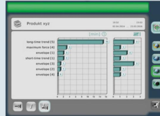
La répartition des erreurs affiche la durée d'immobilisation [min] et la fréquence [unités] des perturbations du processus afin de détecter les principaux problèmes de façon simple et rapide.
