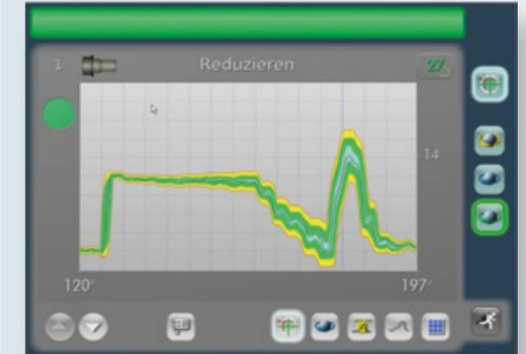
L'Optimizer plus détermine automatiquement la sensibilité/largeur de courbe enveloppe optimale pour l'ensemble du tracé de la courbe enveloppe.
