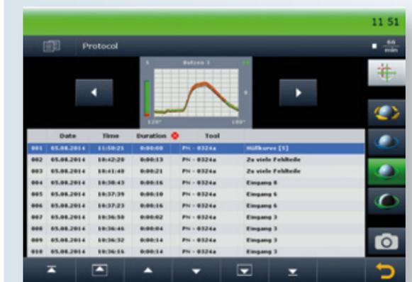
Le protocole sauvegarde les courbes d'erreur avec l'ensemble des données de processus dans le X5.
