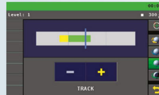
ADM (Automatic Die Match)- Le bargraphe des efforts verticaux de roulage permet de régler le phasage du peigne fixe / mobile (option).
