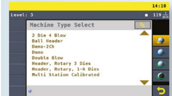
Registre de plusieurs et différents types de machines de frappe à froid ou roulage sont présents dans la mémoire du X3s pour une configuration rapide de la surveillance.
