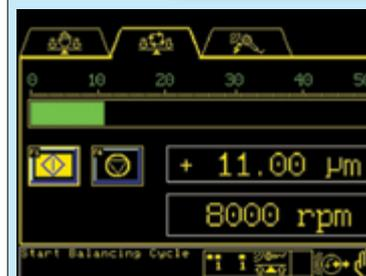
Автоматическая балансировка шлифовального круга
