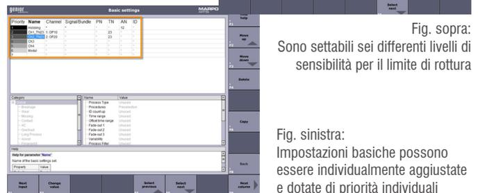
Fig. sopra: Sono settabili sei differenti livelli di sensibilità per il limite di rottura
