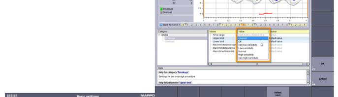
Fig. sopra: Sono settabili sei differenti livelli di sensibilità per il limite di rottura
