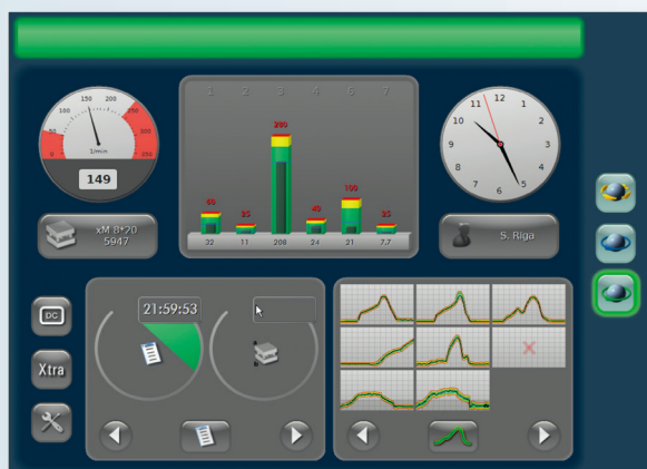
X7メイン画面:機械、チャンネル構成に応じてモニタリングチャンネルを柔軟に切り替え、配置することができます。
