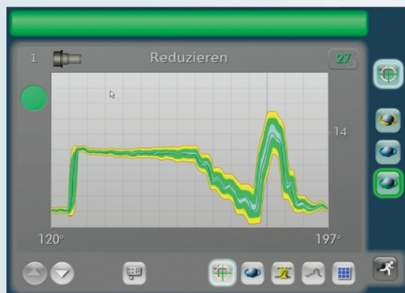
Optimizer plus機能を用いることで、プロセス信号のバラツキの程度に応じて最適なエンベロップカーブ(閾値)を自動的に設定することができます。
