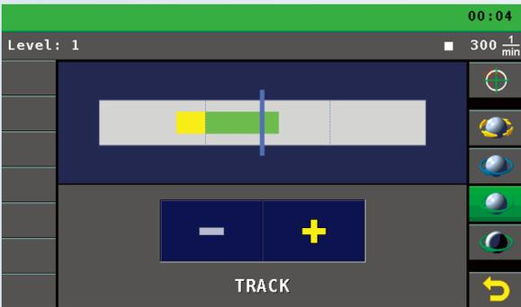
ADM(Automatic Die Match)機能(オプション)では、転造機の固定側ダイと可動側ダイの間の垂直方向の力を示します。
