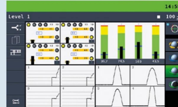
Cockpit Maske zur Anzeige der Regelung und Stoppblockkräfte
