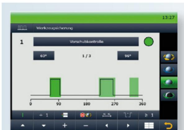
I segnali d'ingresso binari si possono monitorare con max. tre finestre di monitoraggio in modo da assicurare il riconoscimento quanto più veloce possibile degli errori.
