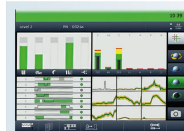
La maschera cockpit presenta in un colpo d'occhio tutte le informazioni rilevanti (valori dei contatori, forze massime, curve di involuppo e limiti delle tendenze).
