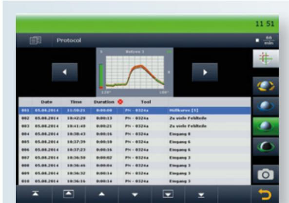
I segnali di ogni canale registrati al momento della fermata sono memorizzati insieme con tutti i dati di processo.
