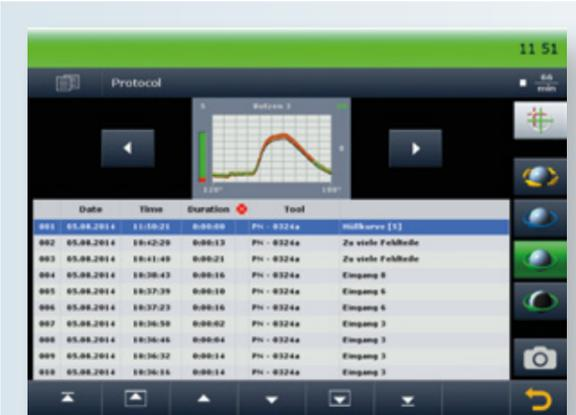
Die Abschaltbilder sämtlicher Kanäle werden zusammen mit den kompletten Prozessdaten im X5 Überwachungsgerät abgespeichert.
