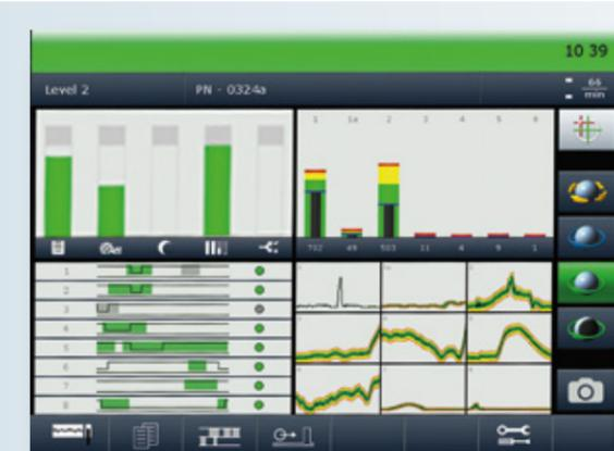
Die Cockpit Maske bietet alle relevanten Informationen (Zählerstände, Maximalkräfte, Werkzeugsicherung und Hüllkurve) auf einen Blick.
