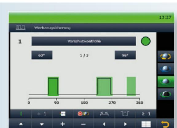
Binäre Eingangssignale können mit bis zu drei Überwachungsfenstern überwacht werden, um eine frühstmögliche Fehlererkennung sicherzustellen.
