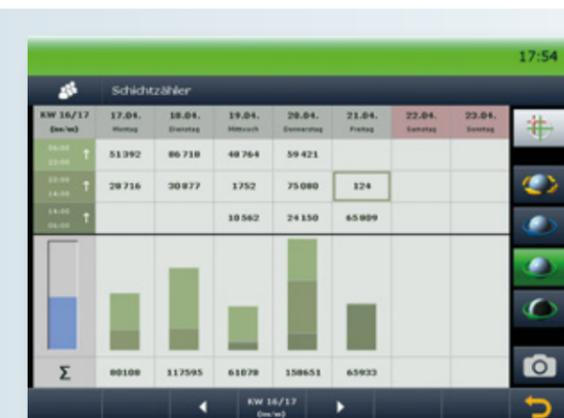
Der X5 Schichtzähler registriert die produzierte Stückzahl je Schicht, Tag und Woche. Die Produktionsleistung mehrerer Wochen kann direkt verglichen werden.
