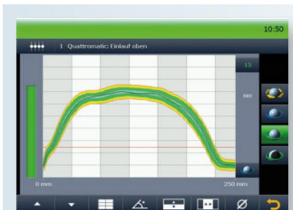
Per una ancor più reale analisi della lavorazione, X5 consente l'indicazione e il monitoraggio delle forze di rullatura con riferimento alla lunghezza dei pettini in mm.
