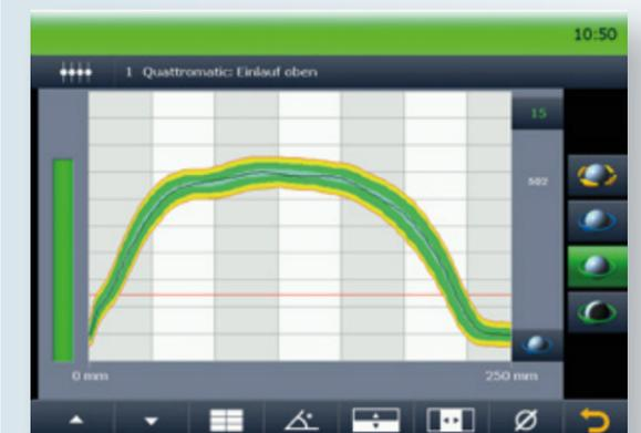
X5 ermöglicht die Anzeige und Überwachung der Walzkräfte zur einfacheren Analyse über die Werkzeuglänge (mm).
