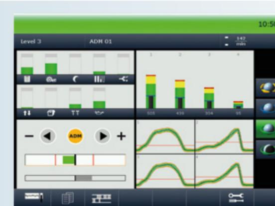
Die Cockpit Maske bietet alle relevanten Informationen (Zählerstände, Maximalkräfte, ADM und Hüllkurven mit Leerlaufgrenzen) auf einem Blick.
