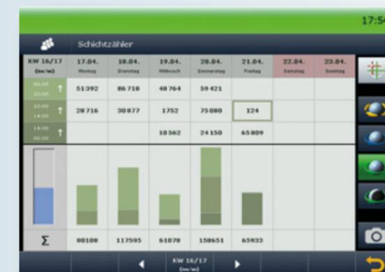
Der X5 Schichtzähler registriert die produzierte Stückzahl je Schicht, Tag und Woche. Die Produktionsleistung mehrerer Wochen kann direkt verglichen werden.
