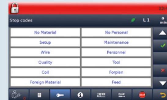
In un elenco liberamente configurabile, i codici di arresto possono essere visualizzati e selezionati dall'operatore. In caso non venga inserito il codice da parte dell'utente, la macchina può essere bloccata.
