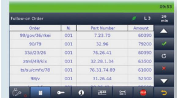
In einer Liste werden die anstehenden Aufträge für die Maschine dargestellt. Der Folgeauftrag kann ausgewählt werden.
