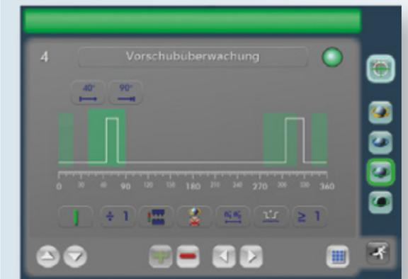
I segnali d'ingresso binari si possono monitorare con max. tre finestre di monitoraggio in modo da assicurare il riconoscimento quanto più veloce possibile degli errori.
