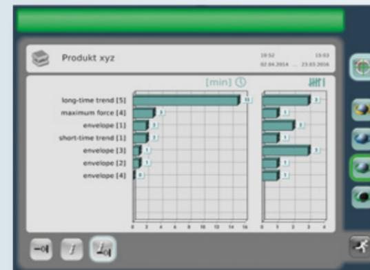
La distribuzione degli errori indica la durata dell'inattività [min] e la frequenza [numero] delle anomalie e permette di rilevare facilmente e velocemente le situazioni più soggette ad errori.
