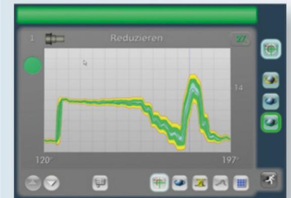
"Optimizer plus" calcola automaticamente i valori ottimali della sensibilità delle curve d'involuppo in ogni singolo punto dell'intero segnale.
