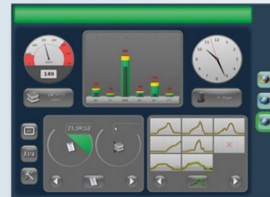
X7 Cockpit: maschere dal design commutabile e con disposizione flessibile dell'ordinamento dei canali di monitoraggio (in base alle caratteristiche della macchina).
