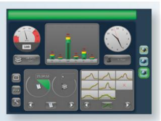
X7 Cockpit: Umschaltbares Masken-Design mit flexibler Anordnung der Überwachungskanäle (gemäß Maschinenaufbau).
