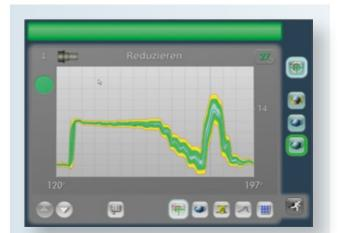
Der "Optimizer plus" ermittelt automatisch die optimale Empfindlichkeit/Hüllkurvenbreite für den gesamten Hüllkurvenverlauf.
