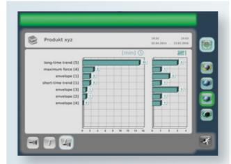
Die Fehlerverteilung zeigt Stillstandsdauer [min] und Häufigkeit [Stck] von Prozessstörungen, um Fehlerschwerpunkte schnell und einfach zu erkennen.
