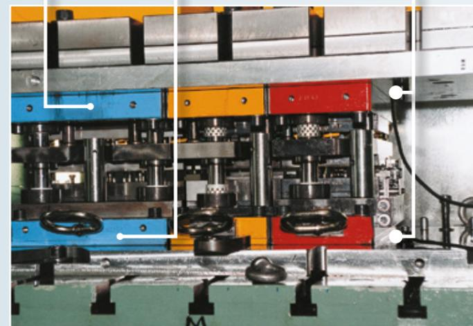
AE Sensoren werden am Ober- und/oder Unterwerkzeug angeschraubt
