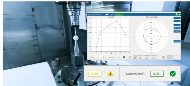
Los parámetros correspondientes a las condiciones de los ejes mecánicos se visualizan y registran para realizar un seguimiento de la historia del estado de la máquina.
