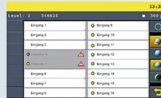
Fino a 16 sensori binari d'avanzamento, espulsione, fine nastro si possono visualizzare in una maschera riassuntiva.
