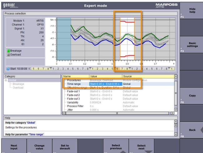
Abb. rechts: Überwachung mit statischen Grenzen
