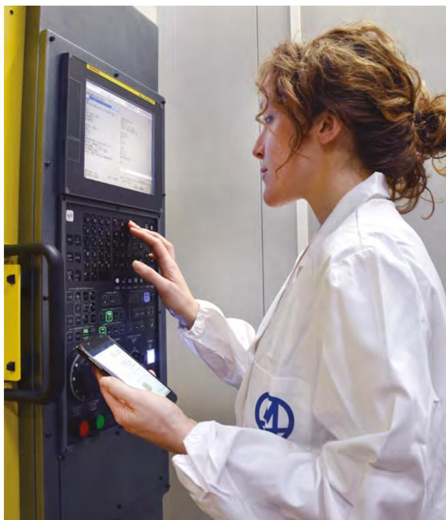
Ready2Probe può essere eseguito su Tablet e Smartphone rendendo possibile consultare la linea di codice generato. Funziona da manuale grafico e permette la programmazione dei cicli di misura Marposs senza essere degli esperti.
