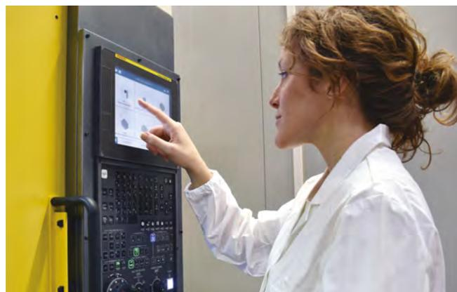
Installato direttamente su CNC Windows based (FANUC iHMI o SIEMENS) permette la programmazione dei cicli di misura trasferendo le chiamate direttamente nel programma di taglio.
