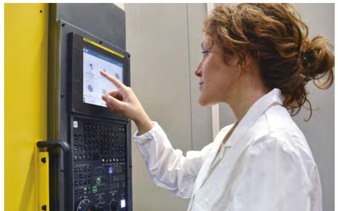
Instalado directamente en CNC basado en Windows (FANUC iHMI o SIEMENS) permite la programación de los ciclos de medida transfiriendo las llamas directamente al programa de corte.
