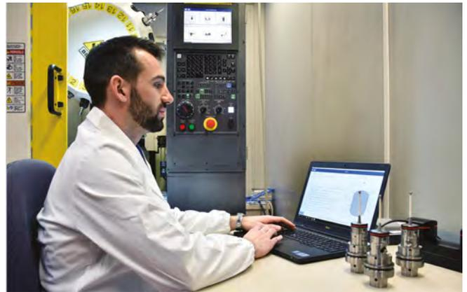
Se puede conectar mediante ETHERNET desde PC Windows y transferir las llamadas a los ciclos directamente en el programa de corte abierto en EDIT en el CNC.
