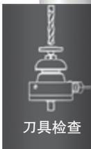
轴向和非轴向刀具长度和半径测量 (刀具预设)
