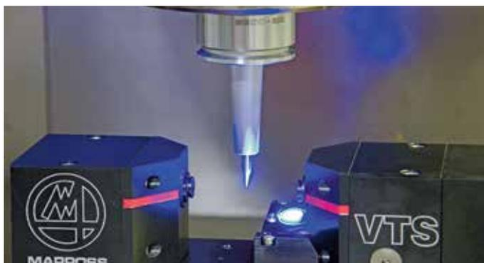
*VTS (Visual Tool Setter) Visuelle Werkzeugvermessung – Werkzeugvermessung mit äusserst hoher Auflösung von Marposs.*
